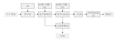
图 3-1 项目污水处理工艺流程图
